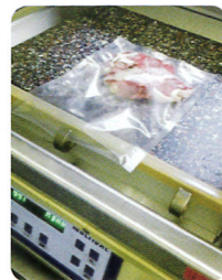
真空→ガス充填→シールを自動処理
